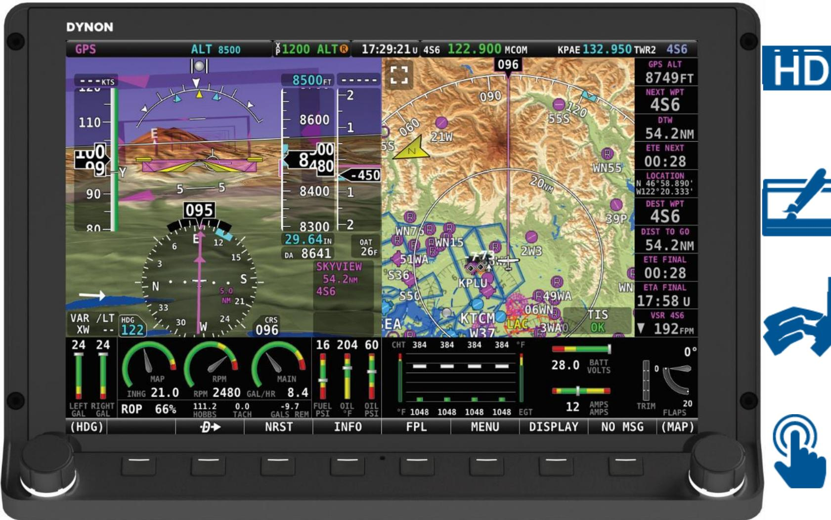
Affichage précis et détaillé: l'écran du SkyView HDX affiche un contraste et un brillant haute résolution avec des angles de vue élargit et des propriétés anti réfléchive pour des images plus nettes.
